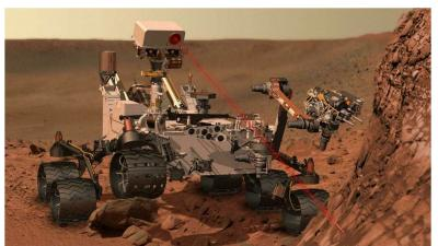
**Document 13**: L'instrument *ChemCam* de *Mars Curiosity* au travail pour analyser la composition du sol martien. (Source : NASA/JPL-Caltech)
