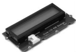
Figure 9 : Photographies d'un écran LCD d'après https://wiki.seeedstudio.com/Grove-LCD_RGB_Backlight/ et d'un avertisseur sonore (« buzzer ») d'après wiki.seeedstudio.com/Grove-Buzzer/
